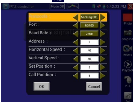
Рис.3.3.1-2 Окно настройки протокола управления камерой (RS485)
