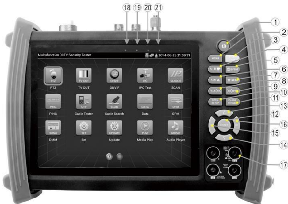
Рис. 2 Элементы экранного интерфейса и органы управления тестеров AVT8600СТА, AVT8600TDR, 8600СТА-ALL
