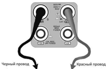
Рис.3.1-1 Подключение измерительного щупа к тестеру.
