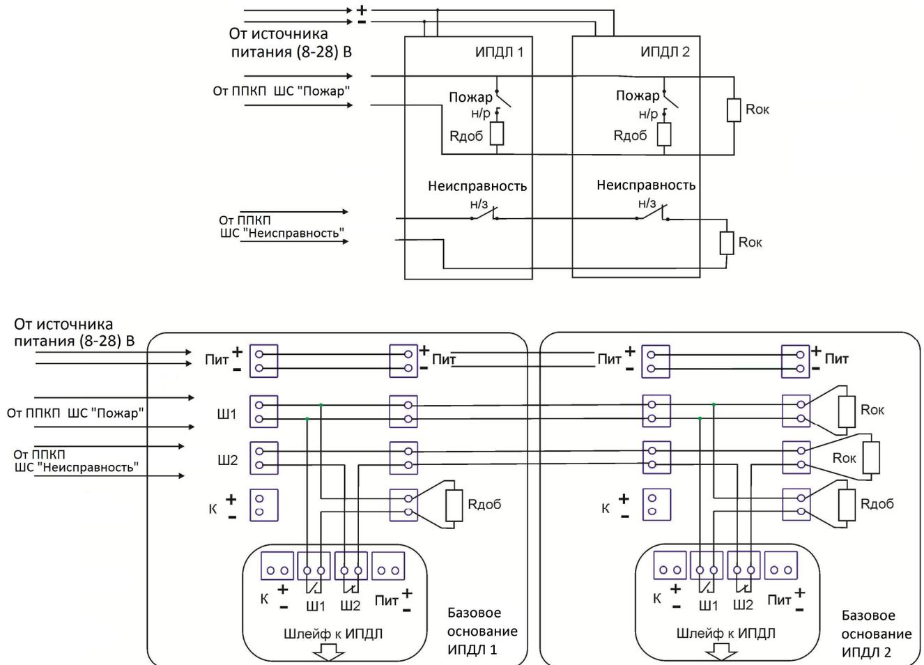
Рисунок 7 - Схема соединения извещателя с ППКП по 6-ти проводному шлейфу
