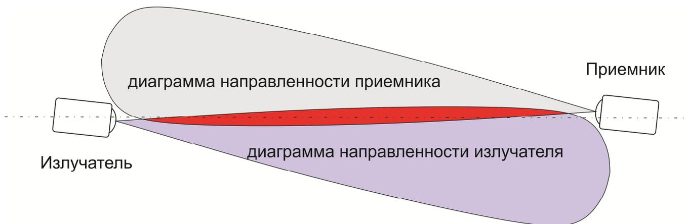
Рисунок 9 - Настройка приемника на край диаграммы направленности излучателя
